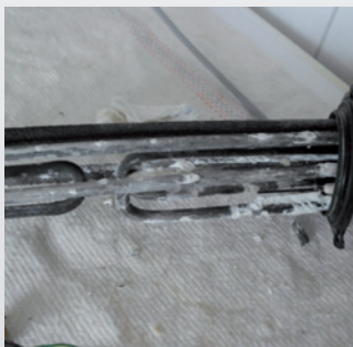
Bild 2: erneuerter Heizflansch nach Testende
