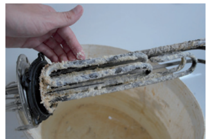
Bild 3: zur Kontrolle ausgebauter Heizflansch nach Testende
