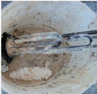
Bild 1: verkalter Heizflansch bei Testbeginn
