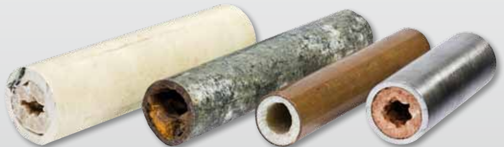
Verkalkte Rohrleitungen, von links nach rechts: Kunststoff, Eisen, Kupfer, Edelstahl
